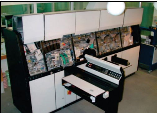
Vollautomatische Banknotenbearbeitung mit ISS 3000 (Deutsche Bundesbank, ca. 1990)
